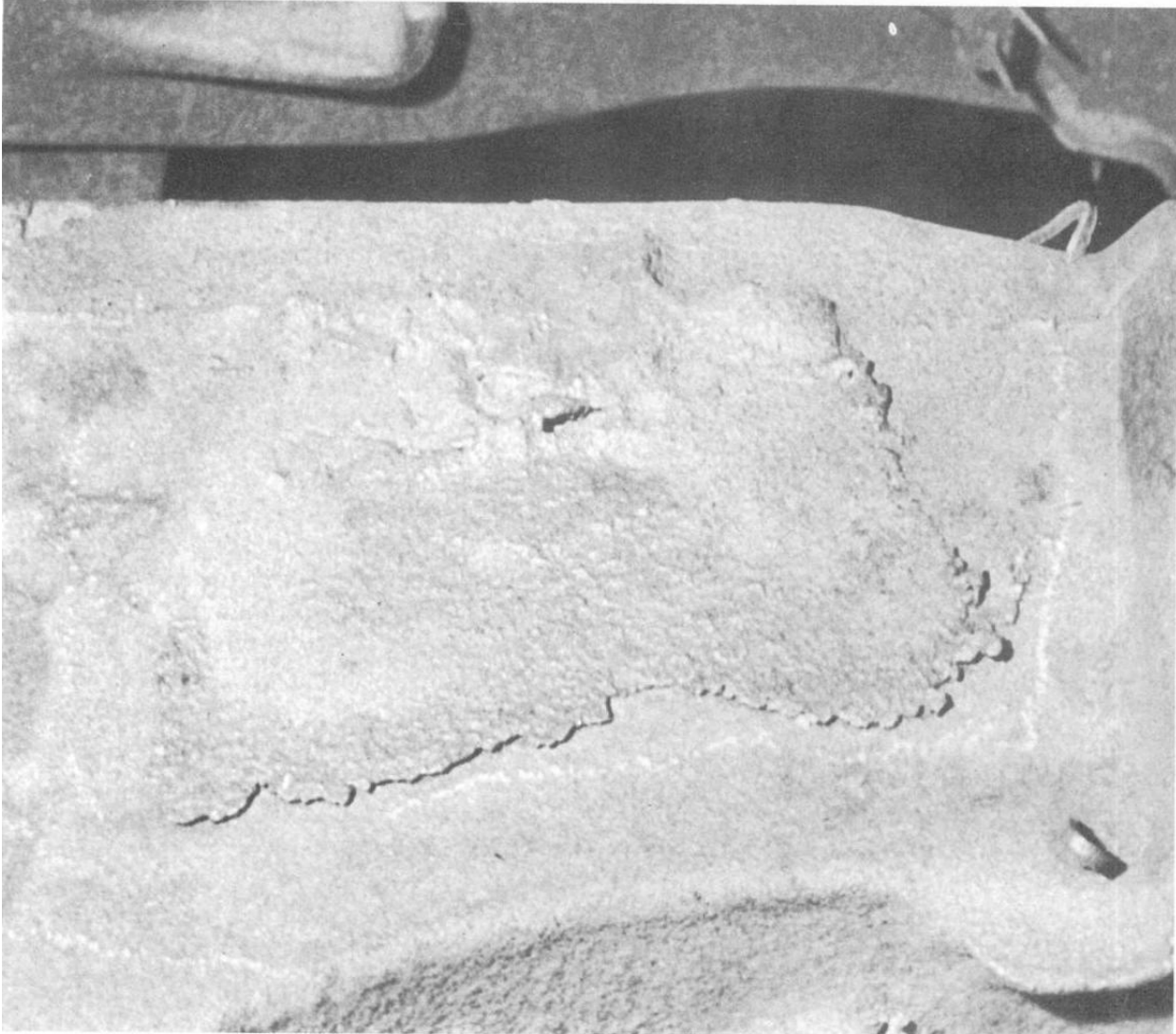
Şekil 9.2. Yavaş döküm hızının, metal teması öncesi üst derecenin aşırı ısınmasına sebep olmasıyla oluşan genleşme dartı.
