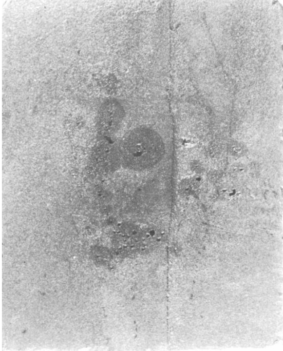
Şekil 11.4. Bir küresel grafitli dökme demirde yolluk sistemindeki türbülans akışın sebep olduğu karınca hataları.
