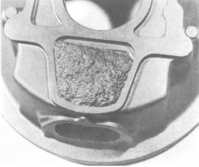
Şekil 7.2. Düşen cepteki yetersiz sıyırma açısı hataya neden olmuştur.
