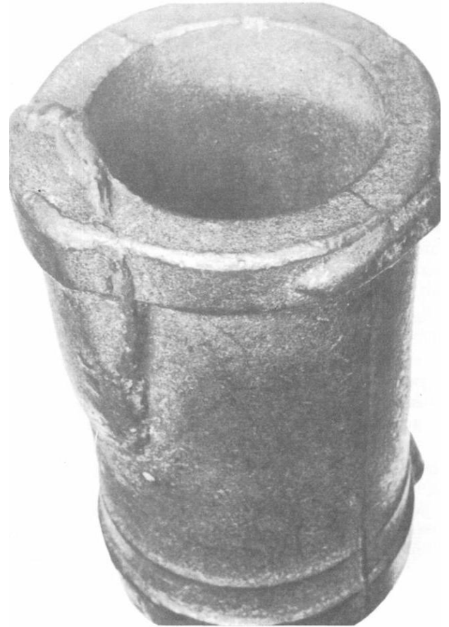
Şekil 30.2. Damarlı kalıp şişmesi
