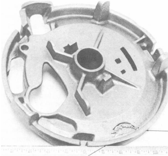
Şekil 5.2. Düşük kum mukavemetinin neden olduğu kum yalaması
