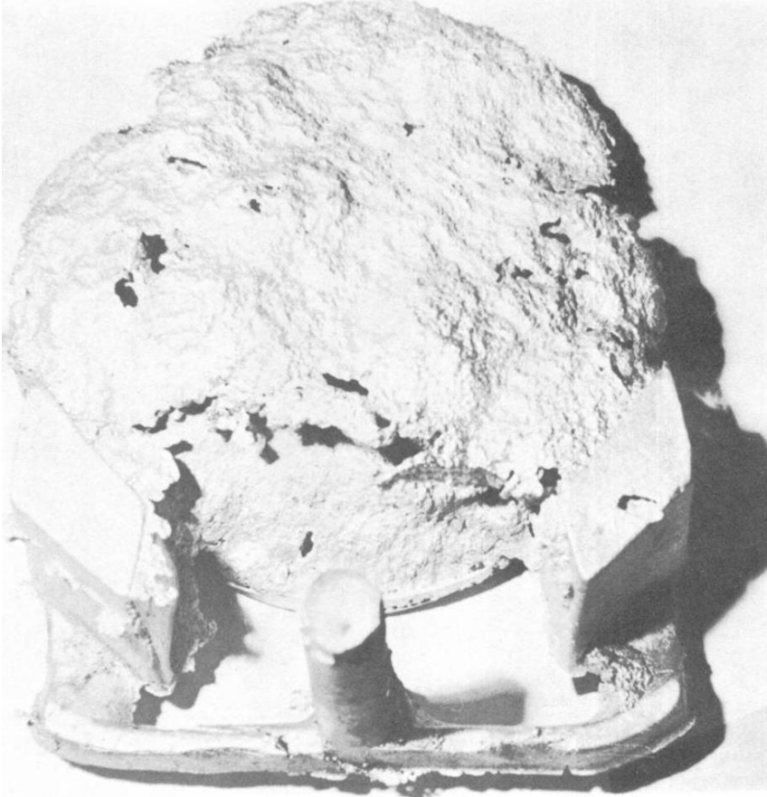
Şekil 7.8. Kalıp üstüne ağırlık düşürülmesi.
