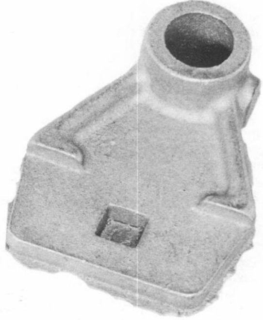
Şekil 30.7. Kalıptaki yumuşak sıkıştırma ayırım yüzeyinde döküm tarafından şişmeye neden olmuştur.
