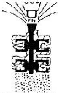
7. Kalıp kırılarak dökülen parça çıkarılır
