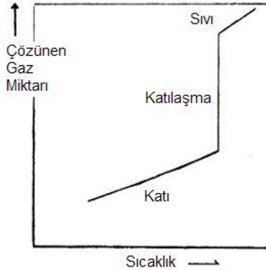
Şekil – 2.1. Metal içinde çözünen gaz miktarının sıcaklık ile değişimi
